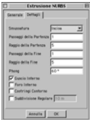
Passo 4. Estrusione NURBS - Dettagli
